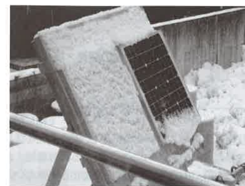
第3図 「サーファシールド G」塗布の親水効果（北海道）
